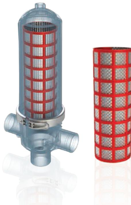
Elek filtreler tarım ve içme suyuna uygun olarak AISI 304 paslanmaz çelikten üretilmiştir. Paslanmaz elek, plastik çerçeve ile güçlendirilerek mukavemeti artırılmıştır. 50-100 Ve 125 mikronlarda elek mevcuttur.
